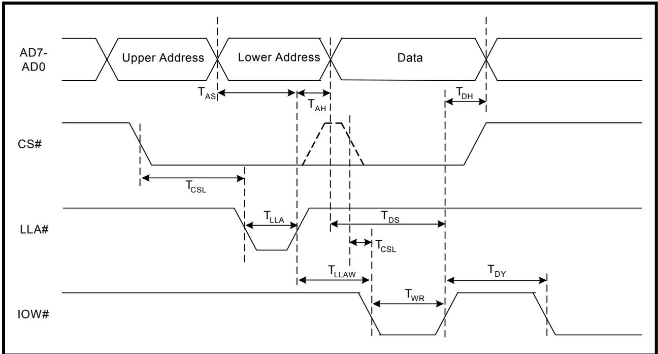
FIGURE 19. RECEIVE READY & INTERRUPT TIMING [NON-FIFO MODE]
