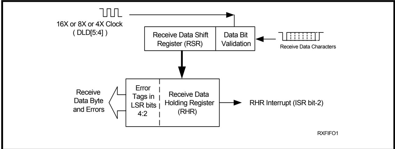
FIGURE 11. RECEIVER OPERATION IN FIFO AND AUTO RTS FLOW CONTROL MODE
