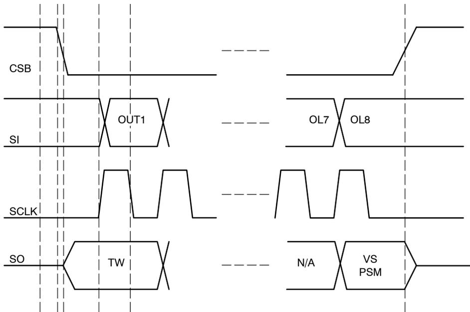
Figure 23. SPI Frame Detail
