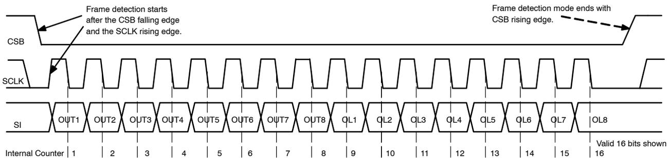
**Figure 24. Frame Detection**
