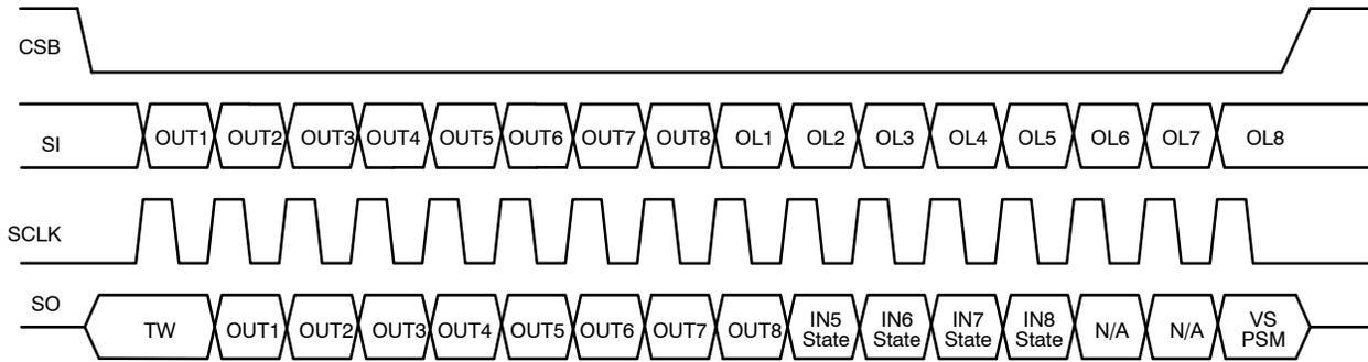
Figure 22. SPI Frame
