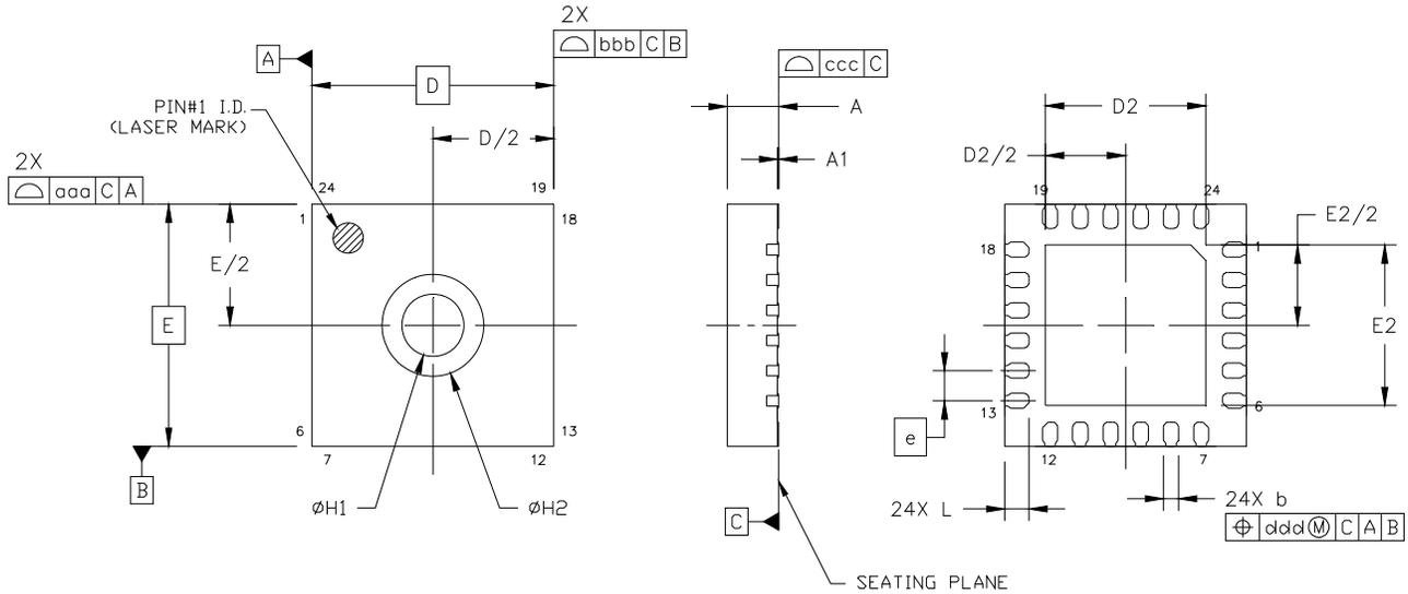
**Figure 8. 24-Pin Quad Flat No Lead (QFN)**
