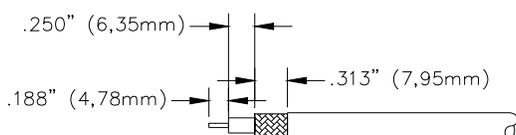
**B** STRIP CABLE JACKET, BRAID, AND DIELECTRIC TO SPECIFICATION LENGTHS. (NOTE: FOIL AND BRAID CABLES SHOULD LEAVE FOIL TO THE END OF DIELECTRIC).
