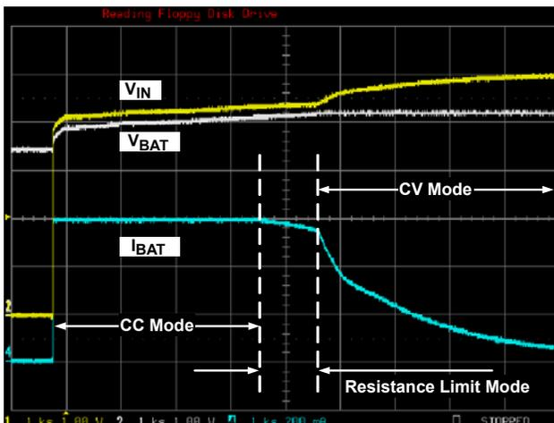
FIGURE 30. SCOPE WAVEFORMS SHOWING THE THREE MODE
