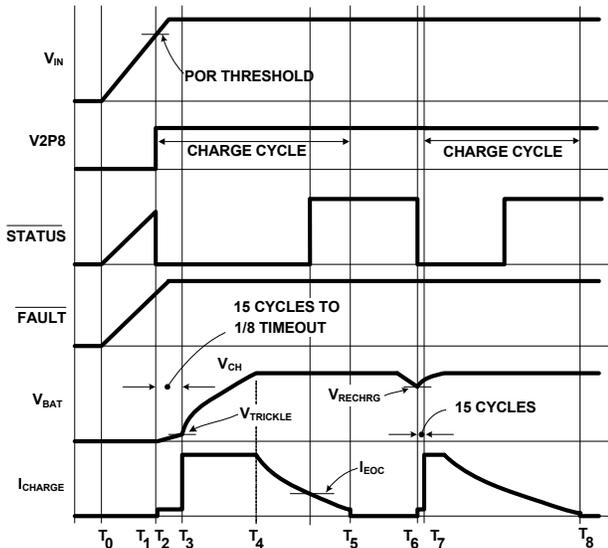
FIGURE 20. OPERATION WAVEFORMS
