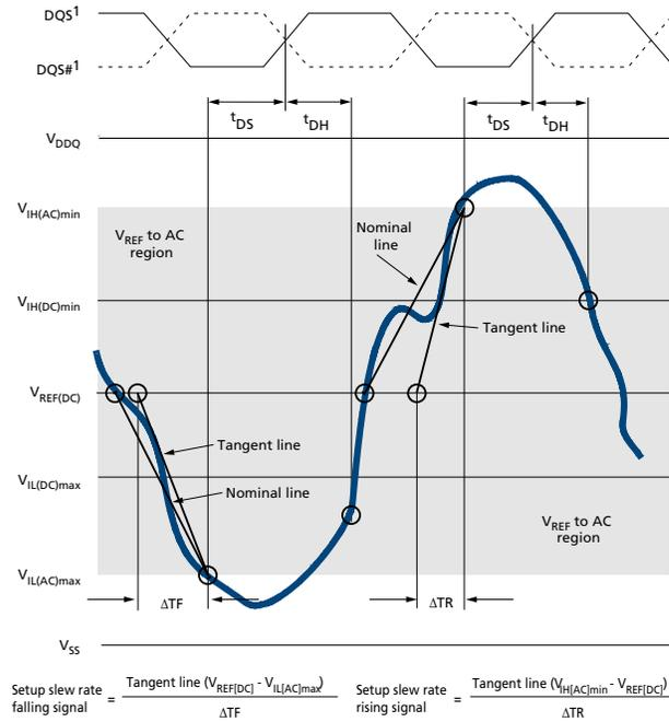
Note: 1. DQS, DQS# signals must be monotonic between  $V_{IL(DC)max}$  and  $V_{IH(DC)min}$ .
