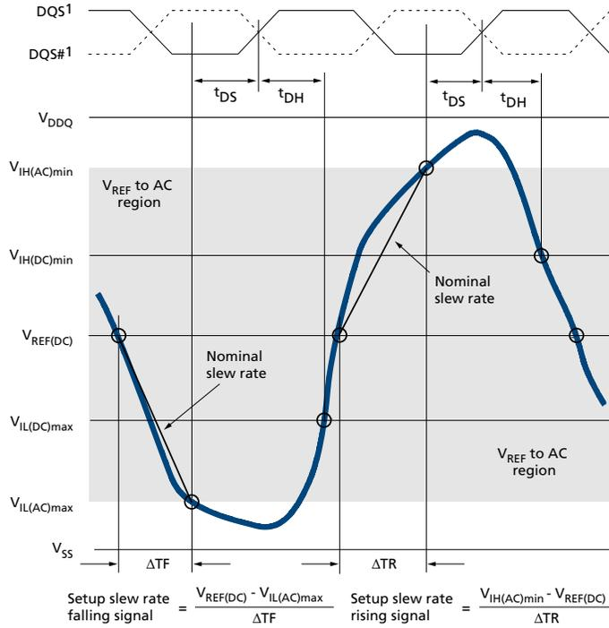
Note: 1. DQS, DQS# signals must be monotonic between  $V_{IL(DC)max}$  and  $V_{IH(DC)min}$ .
