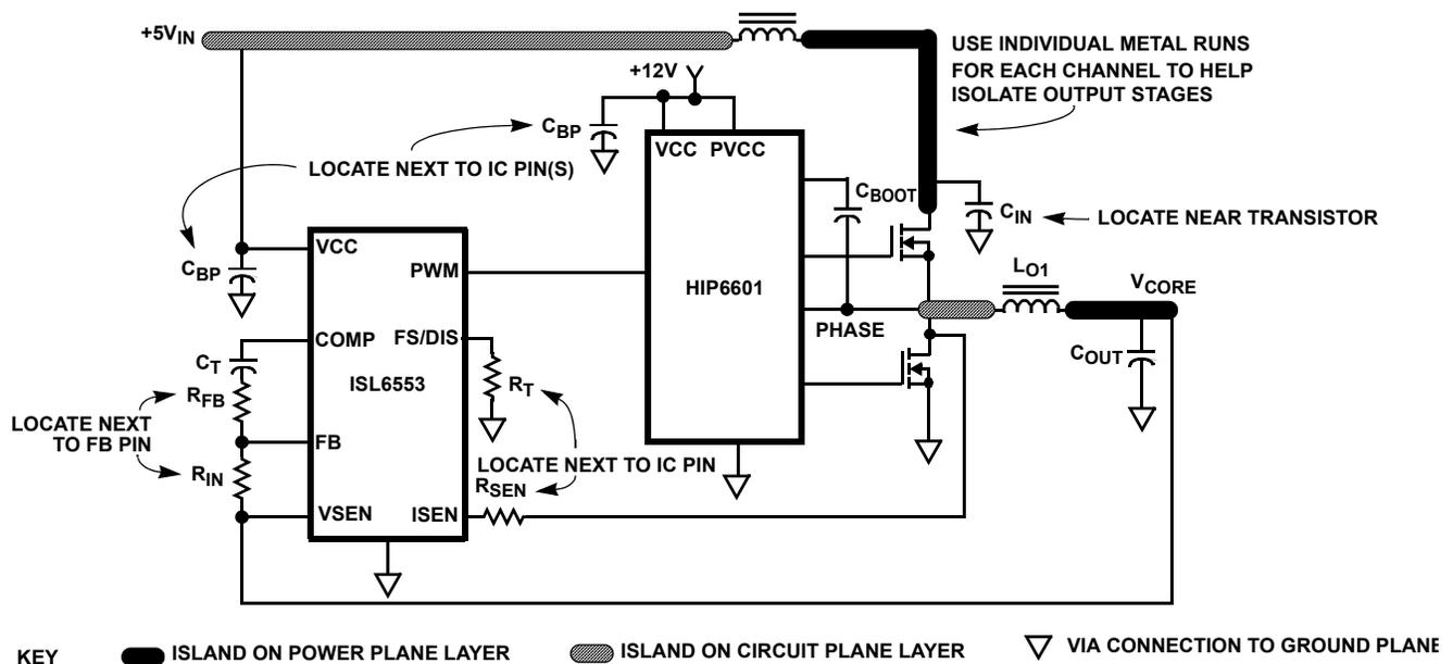
FIGURE 11. PRINTED CIRCUIT BOARD POWER PLANES AND ISLANDS
