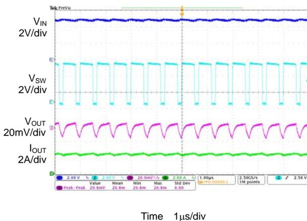
Figure 18.  $V_{OUT}$  Ripple
