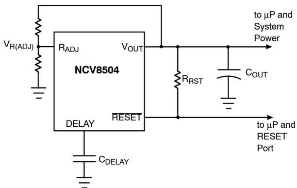
Figure 14. Adjustable  $\overline{\text{RESET}}$
