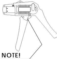
Wenn sich die Handzange verklemmt während dem Verpressvorgang, drücken Sie diesen schmalen Hebel hier zum entriegeln.
