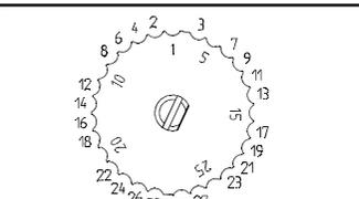
Drehen Sie das Einstellrad im Uhrzeigersinn oder gegen den Uhrzeigersinn, zur korrekten Einstellung der Verpresshöhe.
