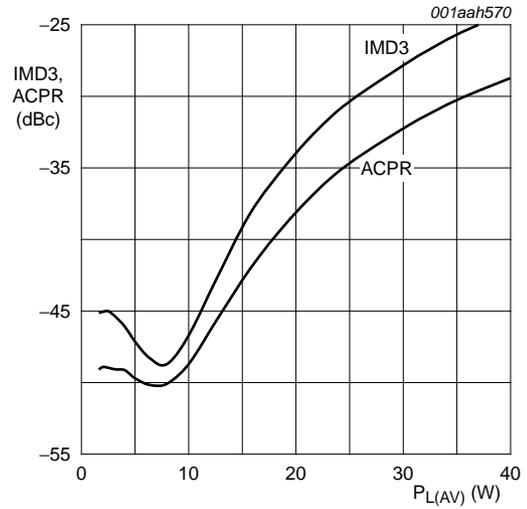
$V_{DS} = 28\text{ V}$ ;  $I_{Dq} = 690\text{ mA}$ ;  $f_1 = 2135\text{ MHz}$ ;
