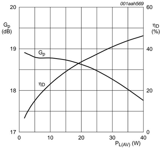
$V_{DS} = 28\text{ V}$ ;  $I_{Dq} = 690\text{ mA}$ ;  $f_1 = 2135\text{ MHz}$ ;
