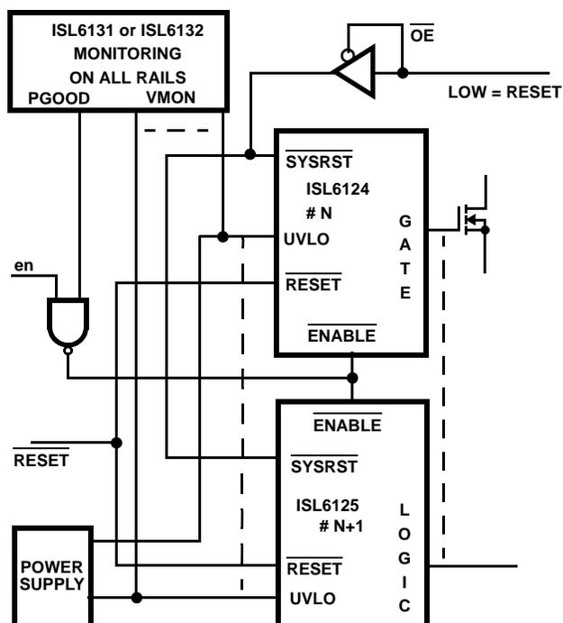
FIGURE 19. ISL612X AND ISL613X VOLTAGE COMPLIANT SEQUENCING BLOCK DIAGRAM
