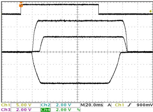
FIGURE 24. ±VOLTAGE SEQUENCING
