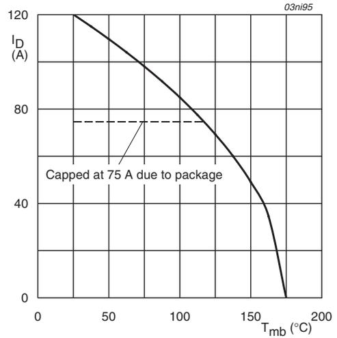
$$V_{GS} \geq 10V$$
