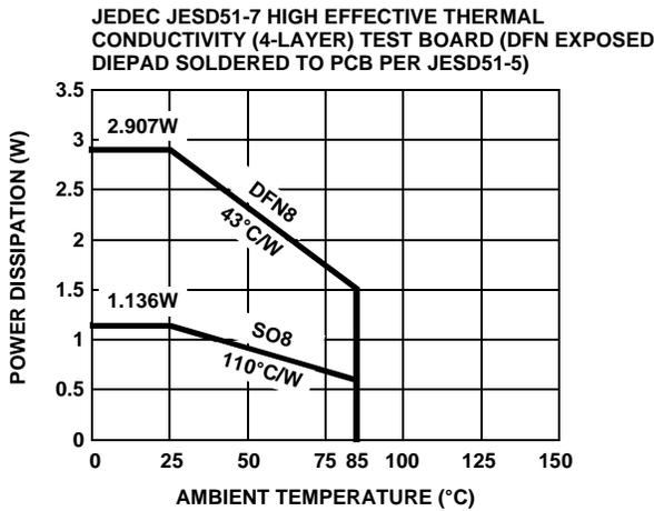
FIGURE 27. PACKAGE POWER DISSIPATION vs AMBIENT TEMPERATURE
