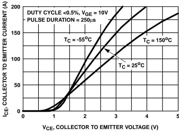
FIGURE 5. COLLECTOR TO EMITTER ON STATE VOLTAGE
