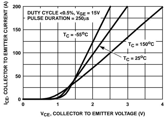
FIGURE 6. COLLECTOR TO EMITTER ON STATE VOLTAGE
