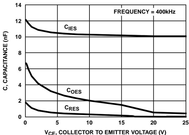
FIGURE 15. CAPACITANCE vs COLLECTOR TO EMITTER VOLTAGE
