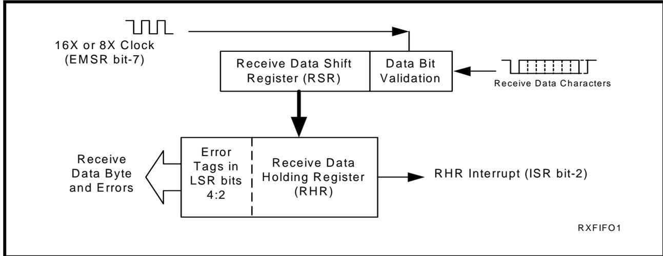
FIGURE 9. RECEIVER OPERATION IN FIFO AND AUTO RTS FLOW CONTROL MODE
