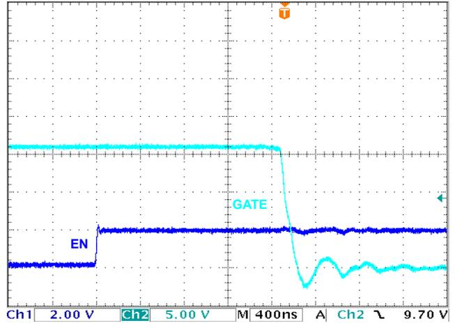
FIGURE 28. ISL6146B/E EN TO GATE OFF DELAY
