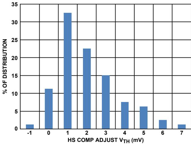
FIGURE 41. HIGH SPEED COMPARATOR OFFSET VOLTAGE DISTRIBUTION
