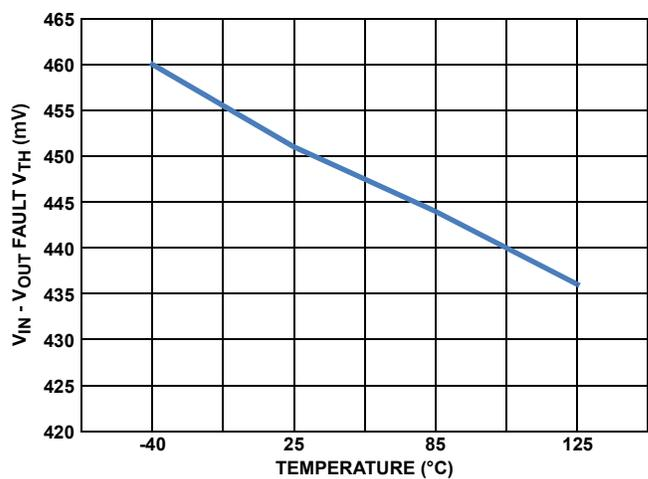
FIGURE 20. V<sub>IN</sub> TO V<sub>OUT</sub> FORWARD FAULT VOLTAGE
