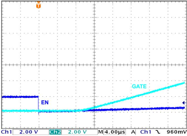
FIGURE 27. ISL6146B/E EN TO GATE ON DELAY
