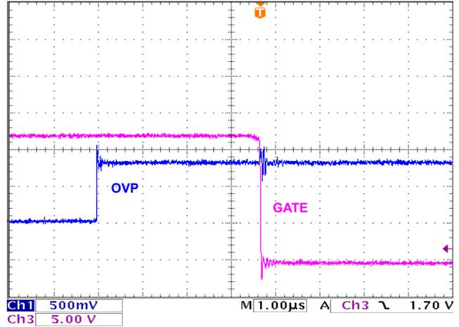
FIGURE 30. ISL6146C OVP TO GATE OFF DELAY
