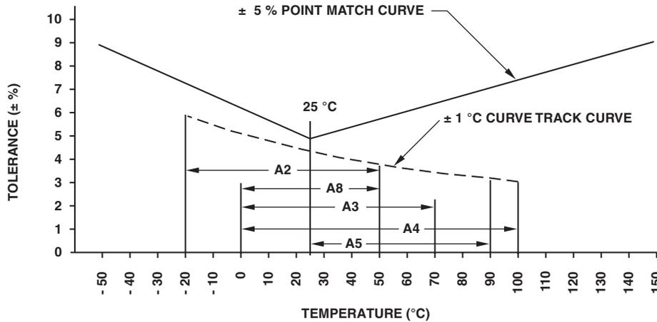
**CURVE TRACKING TOLERANCE**
