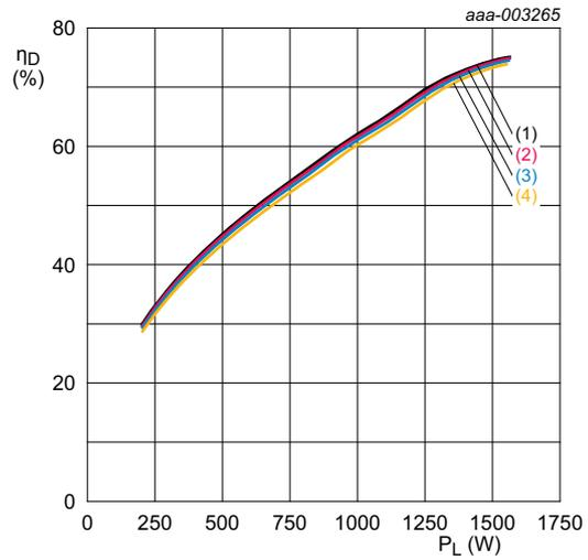
$V_{DS} = 50 \text{ V}$ ;  $f = 108 \text{ MHz}$ ;  $t_p = 100 \text{ }\mu\text{s}$ ;  $\delta = 20 \text{ \%}$ .
