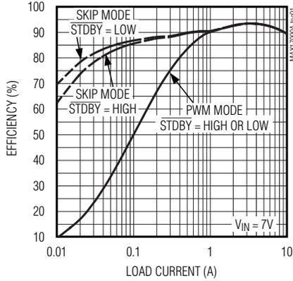
**SMPS 1.5V EFFICIENCY vs. LOAD CURRENT**
