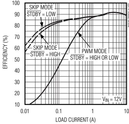
**SMPS 1.5V EFFICIENCY vs. LOAD CURRENT**
