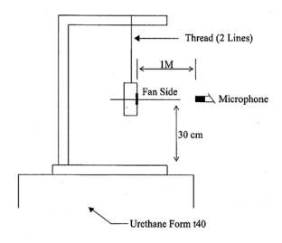
1 METER FROM MICROPHONE TO FAN INTAKE
