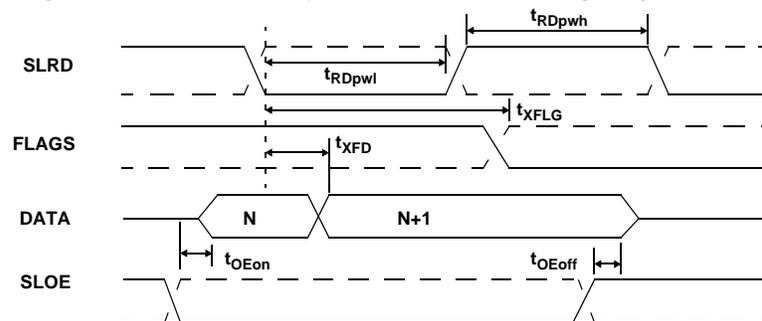
**Table 22. Slave FIFO Asynchronous Read Parameters<sup>[27]</sup>**
