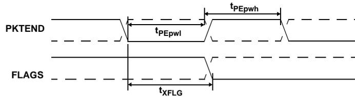
Table 28. Slave FIFO Asynchronous Packet End Strobe Parameters<sup>[27]</sup>
