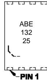
14-Lead SOIC (150 mil) (MCP6H84)
