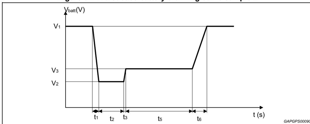
$V_1 = 12\text{ V}$ ;  $V_2 = 6\text{ V}$ ;  $V_3 = 7\text{ V}$
