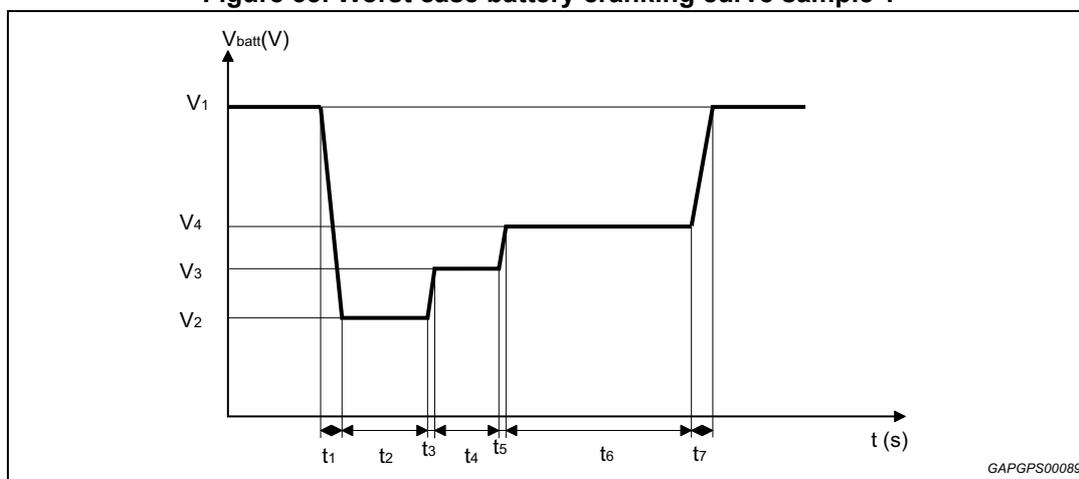
$V_1 = 12\text{ V}$ ;  $V_2 = 6\text{ V}$ ;  $V_3 = 7\text{ V}$ ;  $V_4 = 8\text{ V}$
