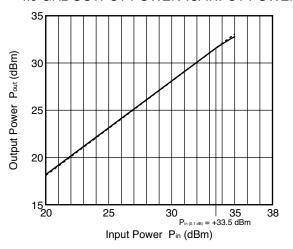
5.2 GHz OUTPUT POWER vs. INPUT POWER
