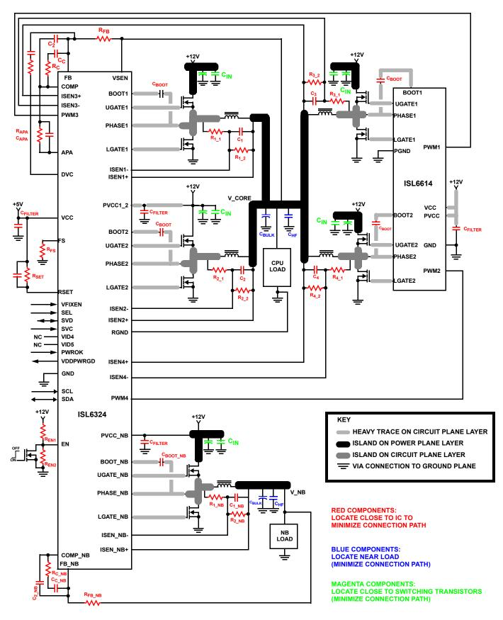
FIGURE 29. PRINTED CIRCUIT BOARD POWER PLANES AND ISLANDS
