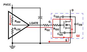
FIGURE 20. TYPICAL LOWER-GATE DRIVE TURN-ON PATH
