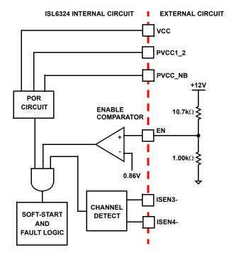
FIGURE 10. POWER SEQUENCING USING
