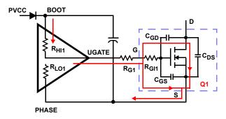
FIGURE 19. TYPICAL UPPER-GATE DRIVE TURN-ON PATH
