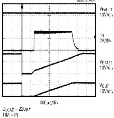
**MAX5943A HOT PLUG-IN LOAD CAPACITANCE
