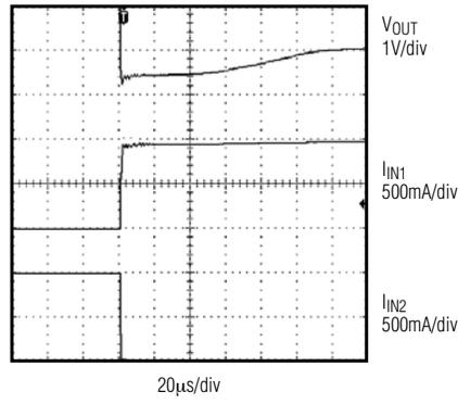
**MAX5943A HOT PLUG-IN LOAD CAPACITANCE
