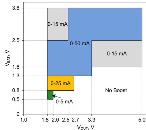
Figure 11-10. L<sub>BOOST</sub> values over V<sub>BAT</sub> and V<sub>OUT</sub>
