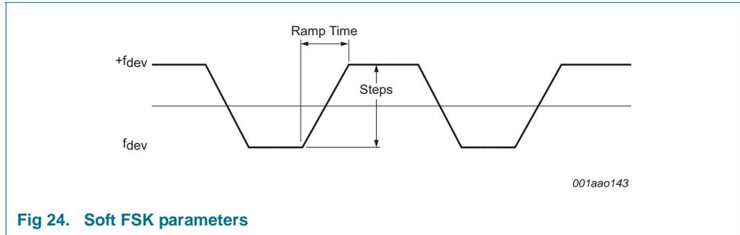
Fig 24. Soft FSK parameters
