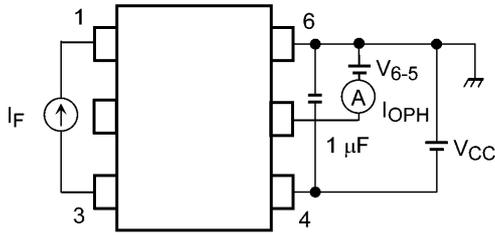
**Fig. 12.1.1 I<sub>OPH</sub> Test Circuit**
