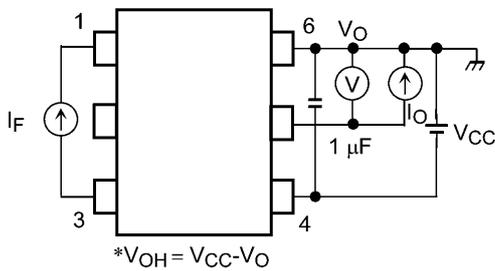
**Fig. 12.1.3 V<sub>OH</sub> Test Circuit**
