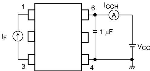
**Fig. 12.1.5 I<sub>CCH</sub> Test Circuit**
