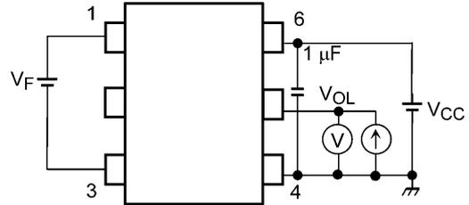
**Fig. 12.1.4 V<sub>OL</sub> Test Circuit**
