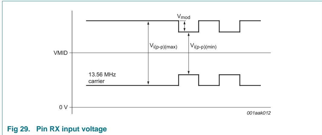
Fig 29. Pin RX input voltage
