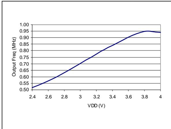
Figure 54. RC Osc Freq vs  $V_{DD}$
