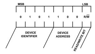
FIGURE 28. SLAVE ADDRESS BYTE DEFINITION
