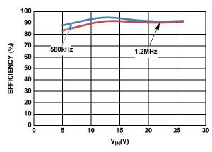
FIGURE 4. EFFICIENCY vs V<sub>IN</sub> vs SWITCHING FREQUENCY AT 20mA (100% LED DUTY CYCLE)
