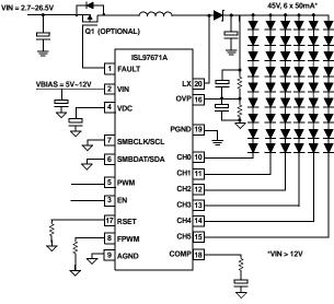
FIGURE 39. DUAL SUPPLIES 2.7V OPERATION
