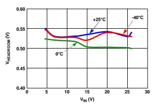
FIGURE 9.  $V_{\mbox{\scriptsize HEADROOM}}$  vs  $V_{\mbox{\scriptsize IN}}$  vs TEMPERATURE AT 20mA
