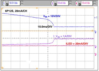
FIGURE 14. LINE REGULATION WITH  $V_{\rm IN}$  CHANGE FROM 26V TO 6V FOR 6P12S AT 20mA/CHANNEL
