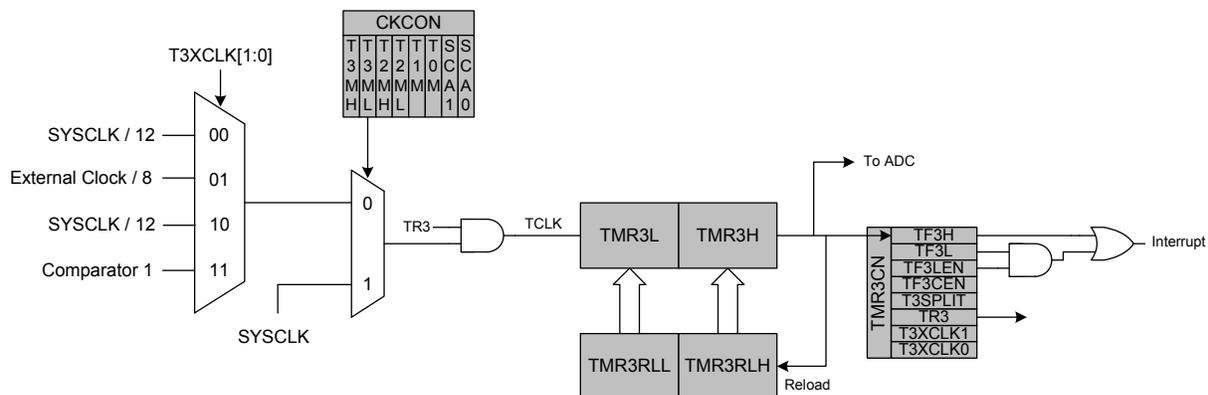
Figure 31.7. Timer 3 16-Bit Mode Block Diagram
