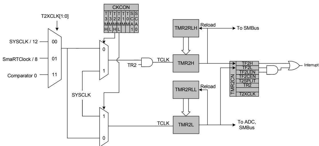
**Figure 31.5. Timer 2 8-Bit Mode Block Diagram**
