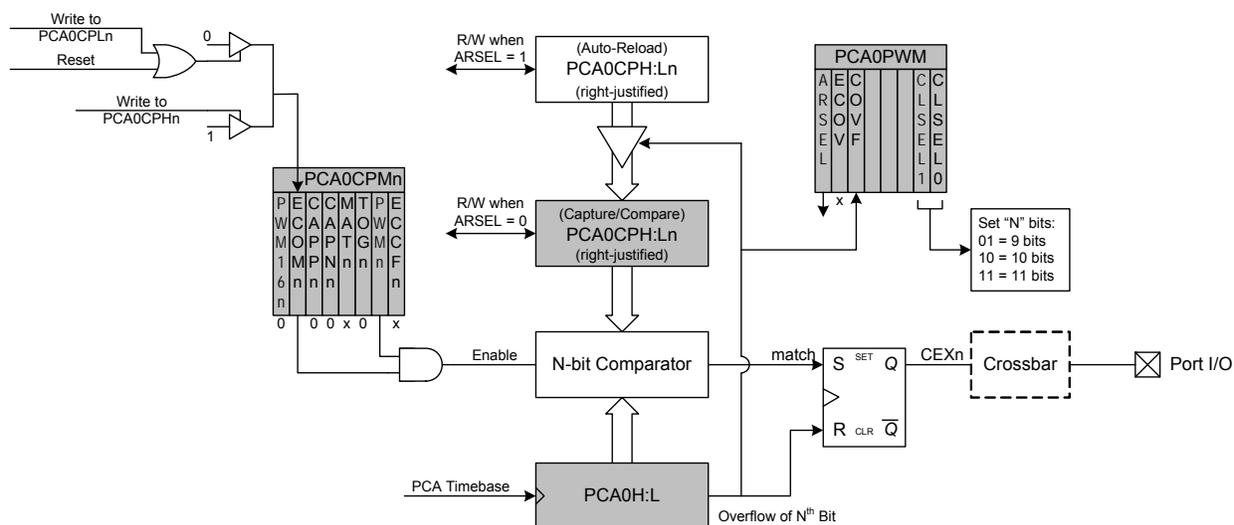
**Figure 32.9. PCA 9, 10 and 11-Bit PWM Mode Diagram**
