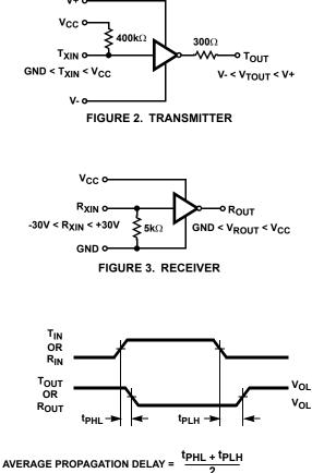
FIGURE 4. PROPAGATION DELAY DEFINITION
