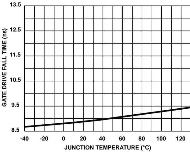
FIGURE 22. GATE DRIVE FALL TIME  $t_f$  vs TEMPERATURE
