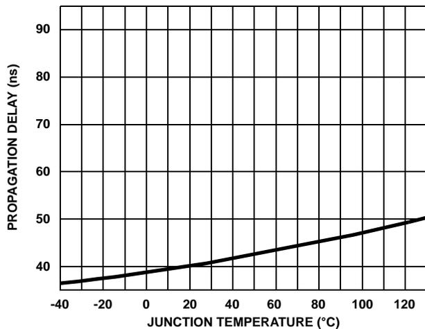
FIGURE 20. LOWER TURN-OFF PROPAGATION DELAY  $t_{LPLH}$  vs TEMPERATURE
