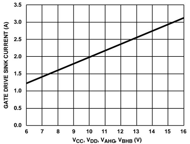
FIGURE 27. PEAK PULLDOWN CURRENT  $I_O$ . BIAS SUPPLY VOLTAGE
