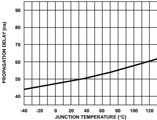
FIGURE 18. UPPER TURN-OFF PROPAGATION DELAY  $t_{HPLH}$  vs TEMPERATURE
