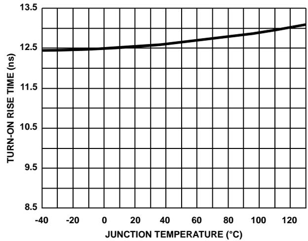
FIGURE 23. GATE DRIVE RISE TIME  $t_r$  vs TEMPERATURE
