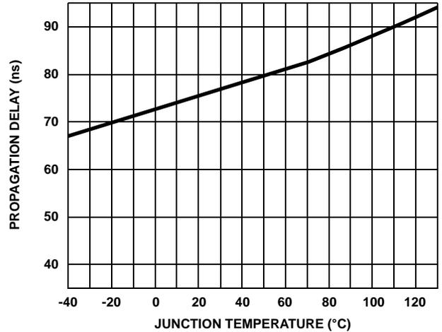
FIGURE 19. UPPER TURN-ON PROPAGATION DELAY  $t_{HPLH}$  vs TEMPERATURE
