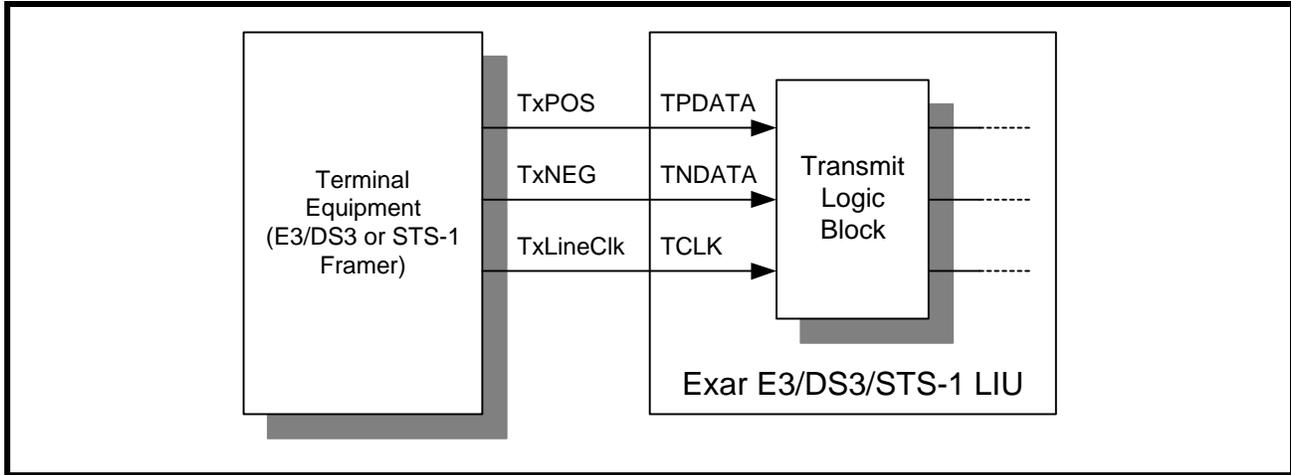
**FIGURE 12. HOW THE XRT73LC00A SAMPLES THE DATA ON THE TPDATA AND TNDA INPUT PINS**
