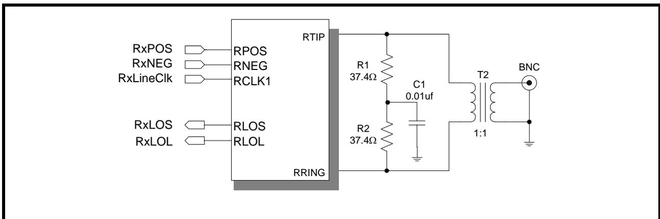
FIGURE 18. RECOMMENDED SCHEMATIC FOR INTERFACING THE RECEIVE SECTION OF THE XRT73LC00A TO THE LINE (CAPACITIVE-COUPLING)
