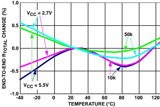
FIGURE 7. END-TO-END R<sub>TOTAL</sub> % CHANGE vs TEMPERATURE
