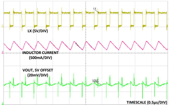
FIGURE 12. PWM MODE OPERATION
