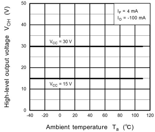
Fig. 13.2.8  $V_{OH} - T_a$
