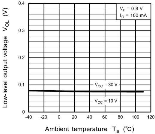
Fig. 13.2.7  $V_{OL} - T_a$
