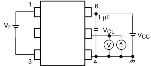
**Fig. 13.1.4 VOL Test Circuit**
