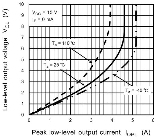
Fig. 13.2.9  $V_{OL} - I_{OPL}$
