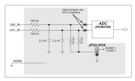
Figure B-6. A/D Converter Inputs
