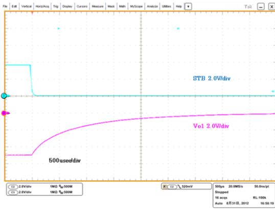
Figure 30. CH1 Discharge waveform
