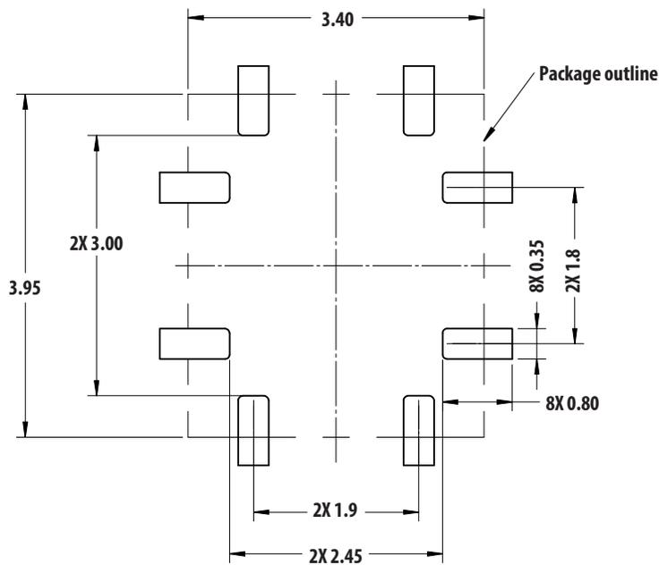
Note: General tolerance  $\pm 0.05\text{mm}$
