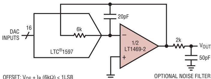
OFFSET:  $V_{OS} + I_B (6k\Omega) < 1LSB$
