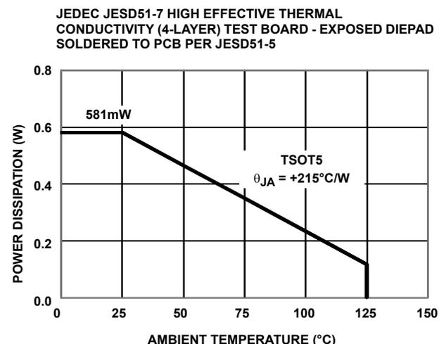
FIGURE 31. PACKAGE POWER DISSIPATION vs AMBIENT TEMPERATURE
