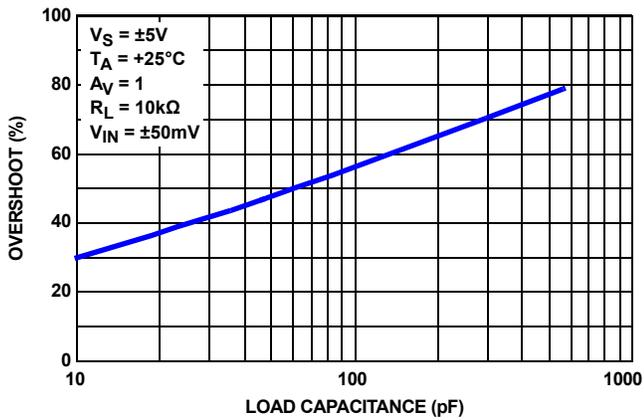
FIGURE 23. SMALL SIGNAL OVERSHOOT vs LOAD CAPACITANCE
