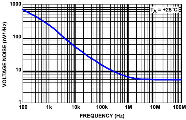
FIGURE 21. INPUT VOLTAGE NOISE SPECTRAL DENSITY vs FREQUENCY
