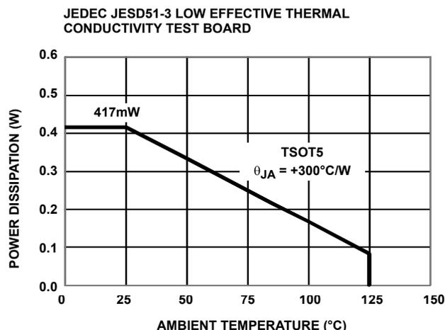
FIGURE 30. PACKAGE POWER DISSIPATION vs AMBIENT TEMPERATURE
