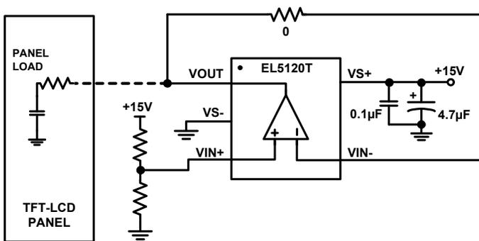
FIGURE 1. TYPICAL TFT-LCD V<sub>COM</sub> APPLICATION
