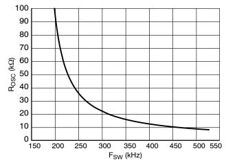
Figure 12. R<sub>OSC</sub> vs. F<sub>SW</sub>
