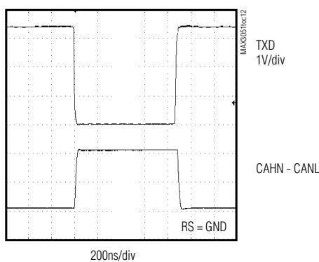
LOOPBACK PROPAGATION DELAY
