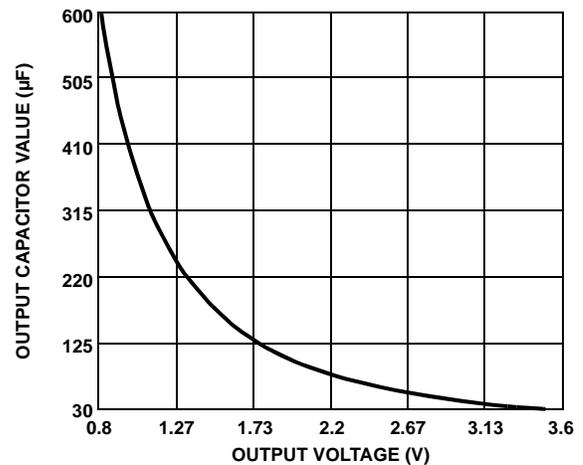
FIGURE 13. THE MAXIMUM CAP vs THE OUTPUT VOLTAGE
