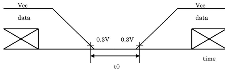
瞬時電圧降下 V<sub>CC</sub>-dip conditions
