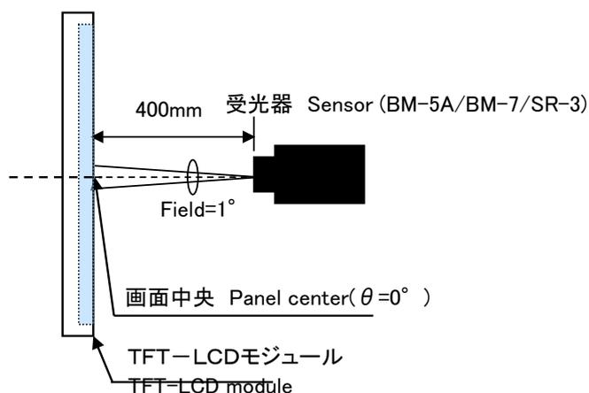
図9-2 輝度/色度/応答速度測定方法
