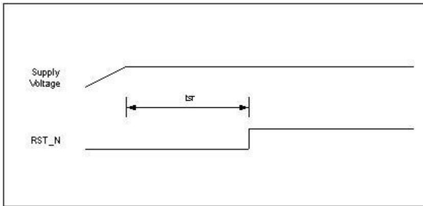
**Figure 27. Reset Timing**
